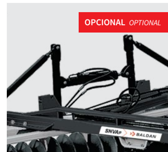
Articulada por pistão. Fold by hydraulic cylinder. Articulación por pistones.
