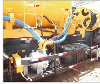
Carretel manual com mangueira hidráulica 1" com 60 m e sistema de hidrojateamento com bomba de alta pressão
