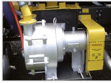
Bomba vácuo e pressão anel líquido 8 m<sup>3</sup>/min ou 12 m<sup>3</sup>/min de vazão de ar
