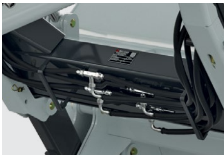
Sistema de mangueiras (PAM 600). Hoses system (PAM 600). Sistema de mangueras (PAM 600).
